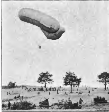
Die Einholung des Ballons auf hügeligem Terrain, wobei das Haltkabel vom Wagen aus um Bäume gezogen wird.
